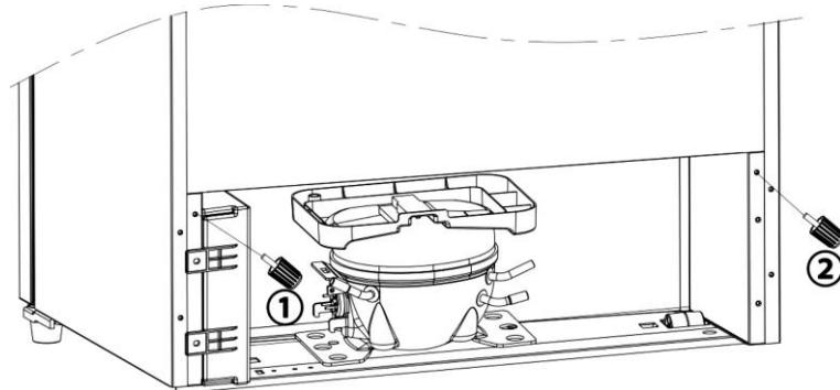
Ниже приведен внешний вид устройства после установки задних упоров:
