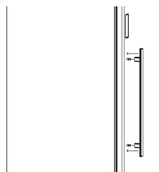
Шаг 3: Затяните винты с помощью 6-гранной отвертки, не прилагая больших усилий
