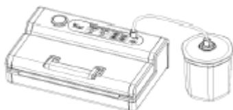
Закрепите один конец вакуум-шланга на патрубке прибора, а другой конец - на патрубке крышки сосуда.
